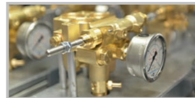
Messing pompkop met inox manometer
